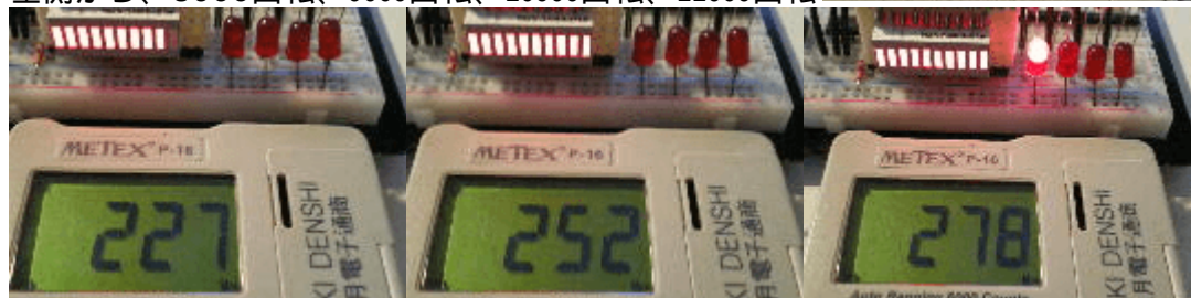
左側から、12000回転、13000回転、14000回転、15000回転以上(上位7個のLEDが点滅)
