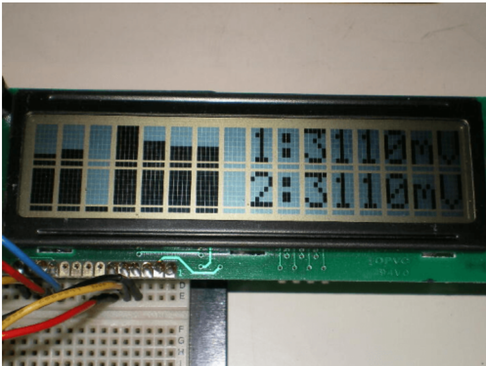
左側:アナログデータのバー表示(CH-1~CH-7) 右側:アナログデータの数値表示(CH-1とCH-2)
