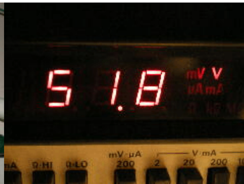
手持ちの電源トランスで動作させて見ました。 約49kHzで最大電圧52Vを取り出すことができます。
